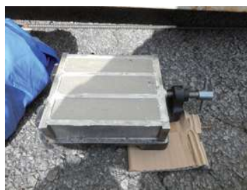
SKY-G1/SKY-CSP60%(W/C)のペースト供試体1日経過。ブリーチングもなく伸縮もなく固化している。
