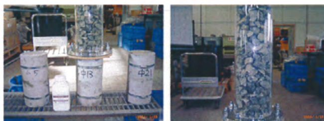
EE産学連携床版防水試験・バラスト防水試験
