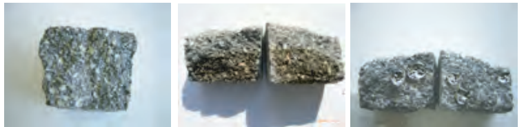
도포 후 충분히 건조 돌 갈라진 부분에 물방울 10일 후에는 전체가 발수
