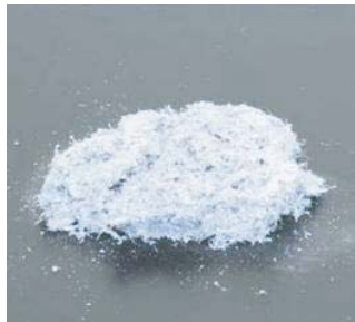
吹き付けアスベストの原料
