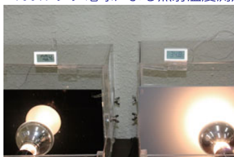
100W レフ電球による照射温度測定
