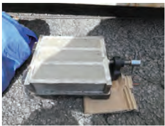
SKY-G1/SKY-CSP60%(W/C) のペースト供試体 1 日経過。ブリーディングもなく伸縮もなく固化している。
