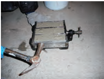
SKY-G1/SKY-CSP60%(W/C) のペースト供試体採取時。通常セメントでは採取直後にはブリーディングが上がりセメントペーストは沈降する。
