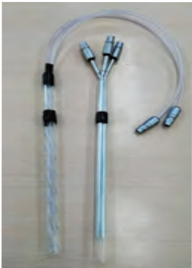
SKY-G1/SKY-CSP60%(W/C) のペースト供試体採取時。通常セメントでは採取直後にはブリーディングが上がりセメントペーストは沈降する。
