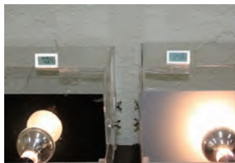
100W レフ電球による照射温度測定
