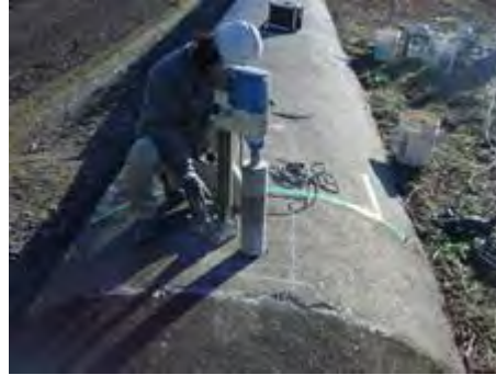
コア抜きによる中性化深さの確認
