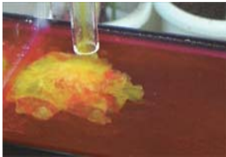
パイプ出口より急激に反応し固形化していく
