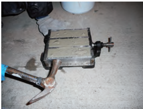
SKY-CSP60% (W/C) のペースト 供試体採取時
