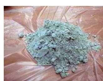
超微细硅石高炉矿渣水泥
