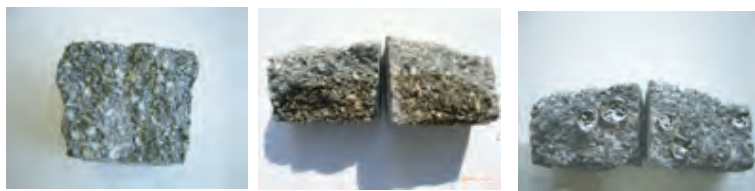
涂抹后，彻底干燥。 破裂的石头上的水滴 10天后，整个表面就变得防水了。
