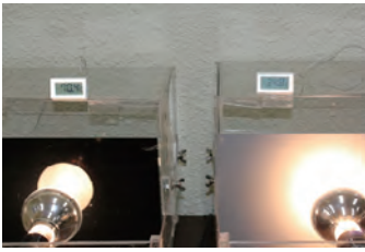
使用100W反射灯泡测量辐射温度
